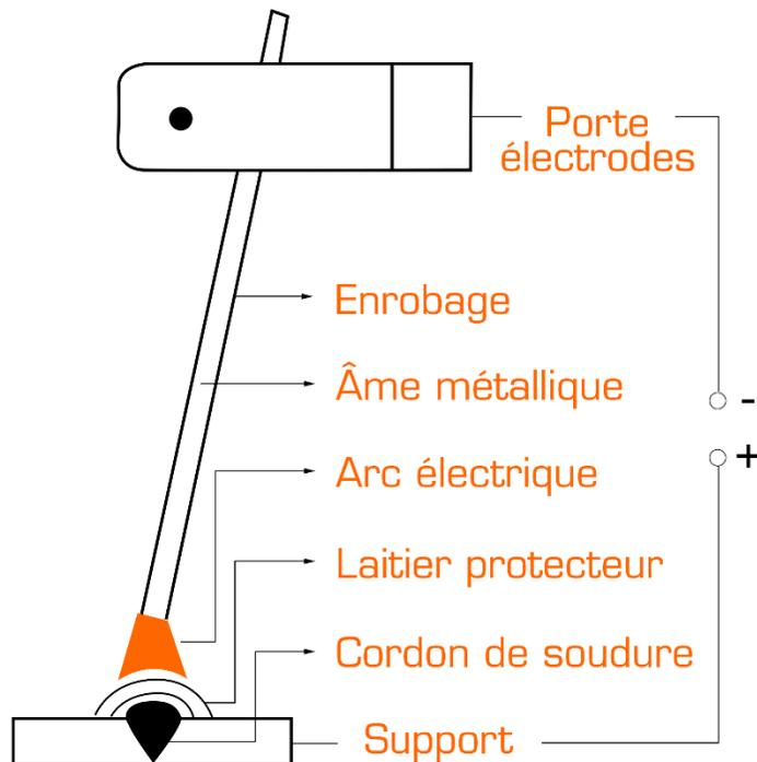
**MMA (Manual Metal Arc)** : soudage à l'arc et à l'électrode enrobée. Le type de poste le plus courant, le plus simple à utiliser et le plus économique.
