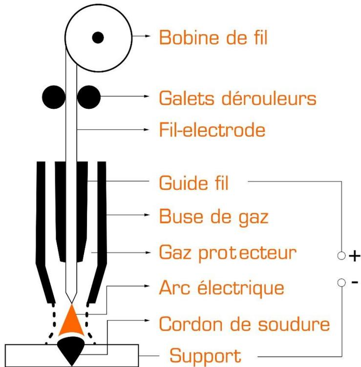
**MIG-MAG (Metal Inert Gaz/Metal Activ Gaz)** : procédé semi-automatique largement répandu dans de nombreux secteurs industriels, comme la construction de navires, de chemins de fer ou encore la fabrication d'équipements lourds ou d'usine.
